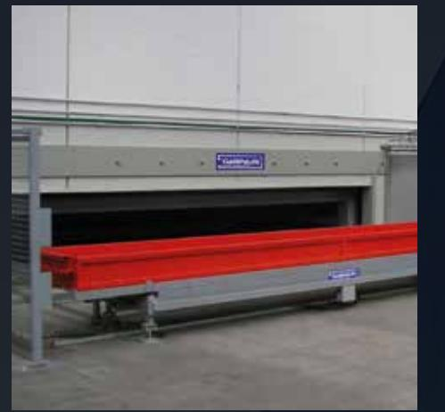
**Il magazzino automatico della materia prima assicura lo stoccaggio di barre fino a 690 tonnellate.**
